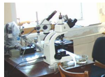
Рис. 3. Рабочее место ихтиопатолога с оптическим оборудованием: микроскоп Микмел-6 с цифровой камерой TourCam (5 Мп), окуляр-микрометром, программой обработки микроскопических изображений Tour View 3.7, бинокляр МБС-10.
